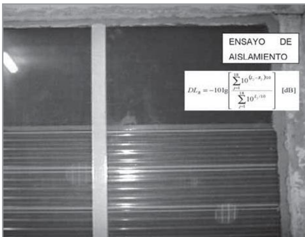
Foto 3. Ensayo de aislamiento.
