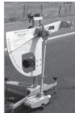
Foto 4. Evaluación de la Resistencia al deslizamiento mediante el Péndulo.
