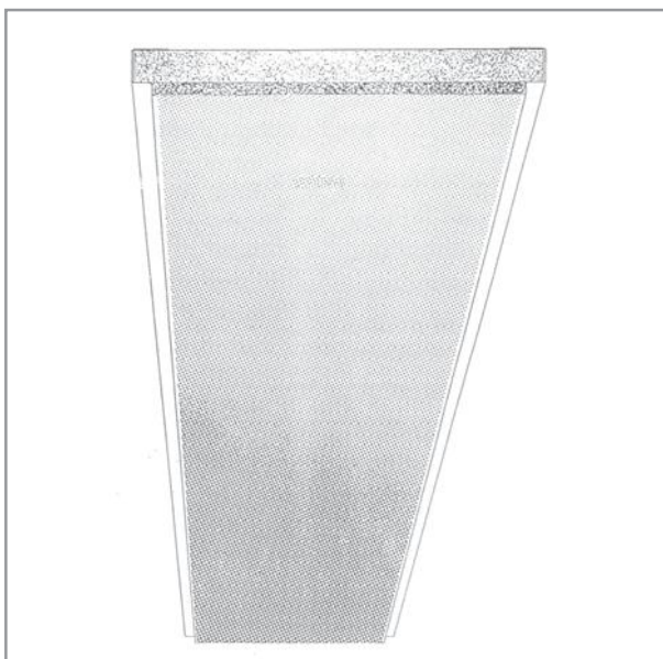
Figura 1. Esquema de un revestimiento absorbente, que aumenta considerablemente la absorción acústica de muros, paredes, túneles, etc.
