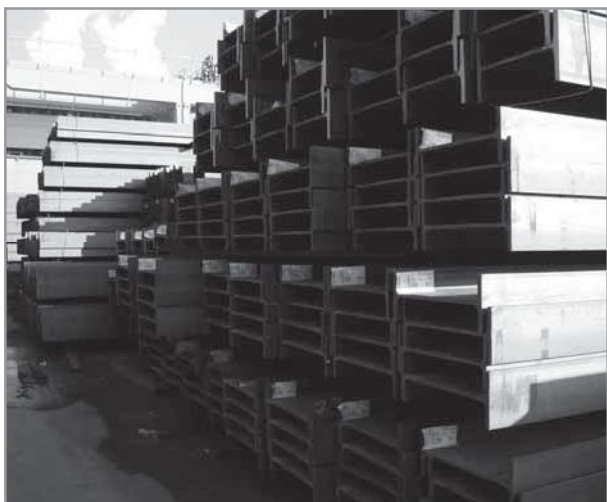
Foto 3. Ejemplo de producto laminado en caliente de acero (en este caso perfil) para estructuras metálicas o mixtas metal-hormigón.
