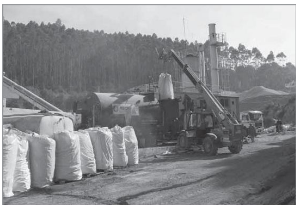
Foto 2. No está claro como se aplicarán los principios del mercado CE a las plantas móviles de producción in situ de los betunes modificados con polvo de neumáticos fuera de uso (NFU) u otros polímeros reciclados, como el polietileno.
